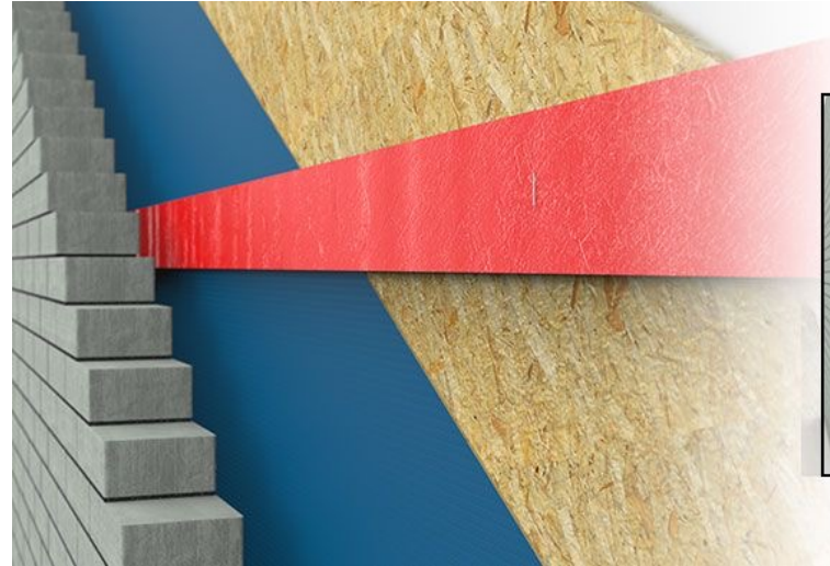
Spouwonderbreking door opschuimende cavity barrier
